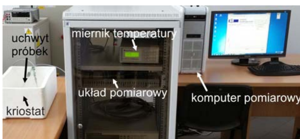
Rys.4. Laboratoryjny układ pomiarowy do wyznaczenia charakterystyki R=f(T) taśm nadprzewodnikowych
