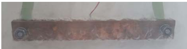
Rys. 8. Próbkę taśmy HTS 2G umieszczoną w uchwycie podczas chłodzenia w ciekłym azocie
