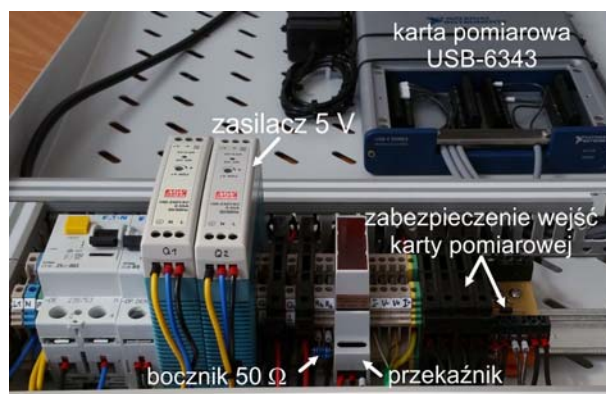
Rys.6. Układ pomiarowy – obwód zasilania i zabezpieczeń
