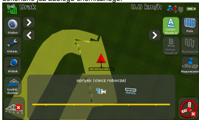
Rys. 12. Wynik pracy układu sterującego sekcjami
