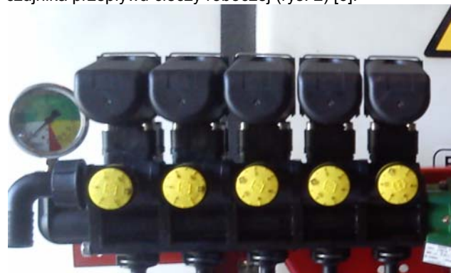
Rys. 1. Zestaw elektrozaworów sterujących poszczególnymi sekcjami belki polowej opryskiwacza
