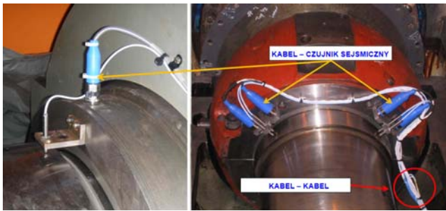
Rys. 1. Przykład instalacji czujników umożliwiających pomiar drgań absolutnych wirnika: czujnik zbliżeniowy oraz czujnik sejsmiczny przymocowane do łożyska (z lewej) oraz czujniki redundantne w konfiguracji XY (z prawej).
