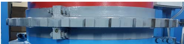
Rys.3. Widok fragmentu „nieprawdziwego” koła zębatego wykorzystywanego do detekcji obrotów maszyny wolno-obrotowej.
