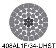
Rys. 1. Przekrój poprzeczny przewodu referencyjnego oraz przewodów wybranych do obliczeń konstrukcji nowych słupów
