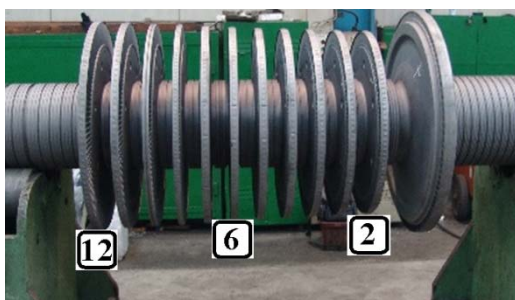
Rys.1. Wirnik WP – oznaczenie stopni łopatek
