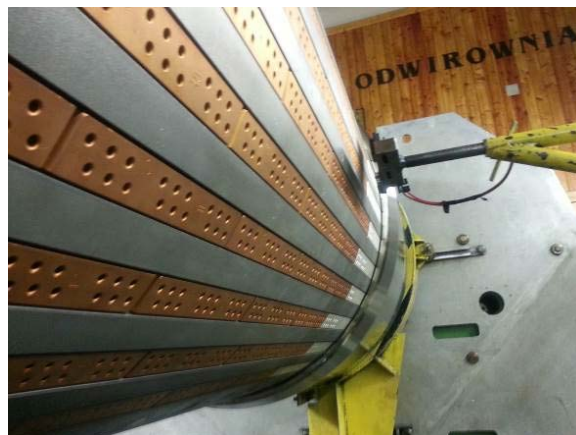
Rys. 9. Sonda pomiarowa zainstalowana na odwirowni
