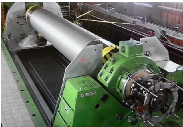
Rys. 3. Wirnik generatora podczas pomiarów elektrycznych [3]
