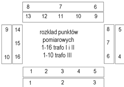
Rys. 5. Rozmieszczenie punktów pomiarowych po obwodzie transformatora w dwu poziomach
