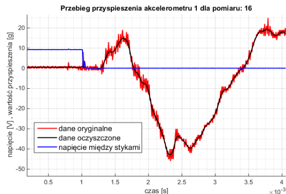
Rys.7. Fragment przebiegu przyspieszenia drgań jednej ze stycek
