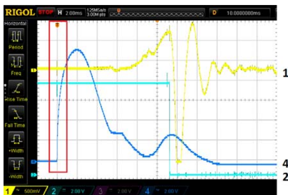
Rys.9. Oscylogram przebiegów: przyspieszenia (1), prądu cewki wyzwalającej (4) i napięcia na stykach nieruchomych (2) dla jednego z pomiarów po modyfikacjach stanowiska
