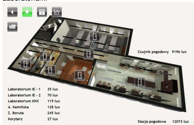
Rys. 8. Widok Laboratorium SKNXiOEEI z wynikami pomiarów natężenia światła dziennego na zewnątrz budynku oraz w pomieszczeniach
