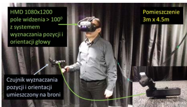
Rys.6. Elementy systemu pozycjonowania głowy i broni.
