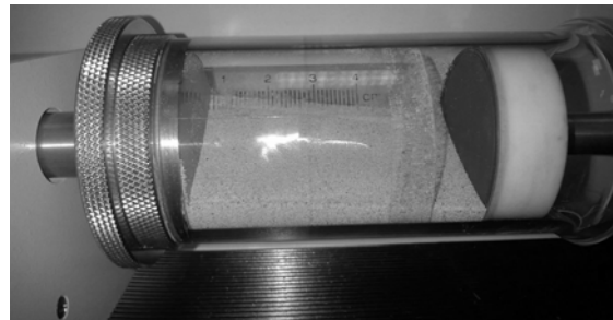
Rys.6 Komora pomiarowa Piknometru GeoPyc 1360
