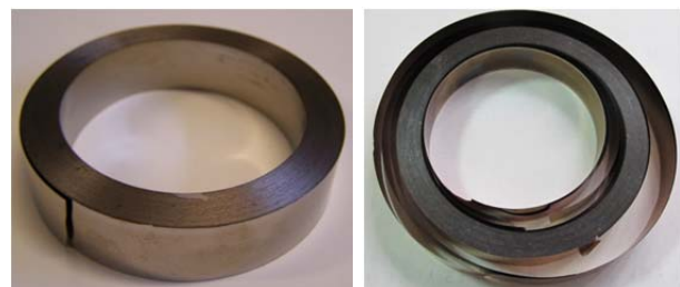
Rys.9. Rdzeń toroidalny wykonany z taśmy amorficznej o grubości 25 \mu m : a) po sklejeniu żywicą, b) przed klejeniem
