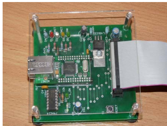
Rys.6. Zdjęcie układu łączącego (przeładowanie) modułu IIM7010A z systemem DSM-51, wraz z włożonym modułem IIM7010A
