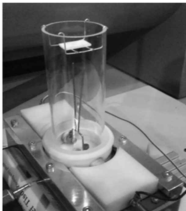
Rys.4. Miniaturowy reaktor plazmowy z płytka teflonową poddawaną obróbce
