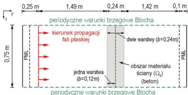
Rys.1. Geometria rozpatrywanego modelu stosowana przy obliczeniach układów z materiałem jednorodnym
