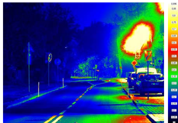
Rys. 8. Wynik pomiaru rozkładu luminancji, na badanym odcinku ulicy Batorego, wykonany matrycowym miernikiem luminancji - położenie prawe obserwatora
