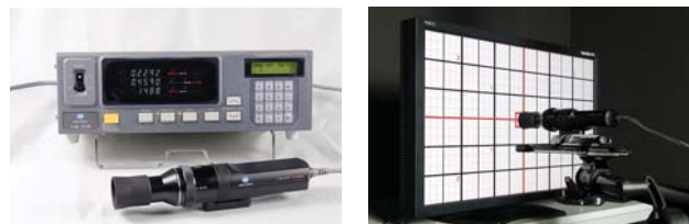
Rys. 4. Kolorymetr Konica Minolta CA-310: jednostka sterująca wraz z głowicą pomiarową (obraz lewy), głowica pomiarowa w trakcie jej pozycjonowania na monitorze (obraz prawy)
