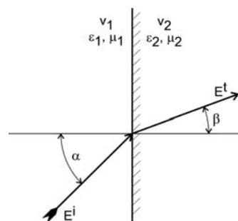
Fig. 5. Refraction
