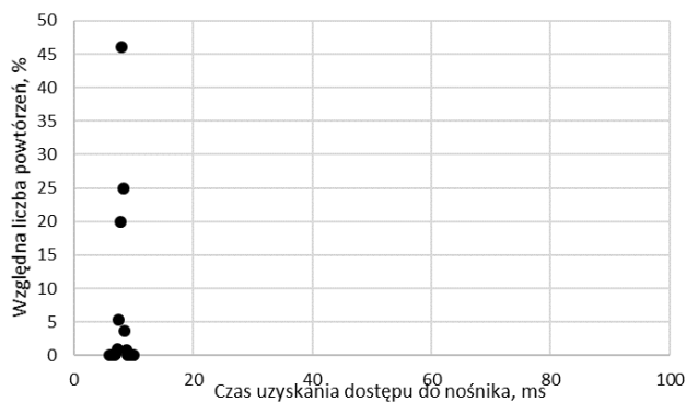
Rys. 6. Rozrzut czasu dostępu do nośnika dla ZigBee przy braku sieci teleinformatycznej
