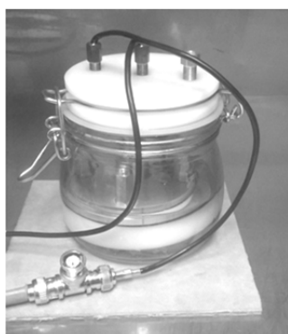
Rys. 12. Szczelne naczynie wraz elektrodami i umieszczoną między nimi próbką preszpanową
