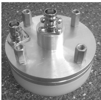
Rys. 10. Trójelektrowy układ elektrod pomiarowych
