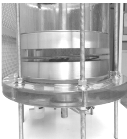
Rys. 4. Widok układu elektrod i próbki w czasie pomiędzy pomiarami
