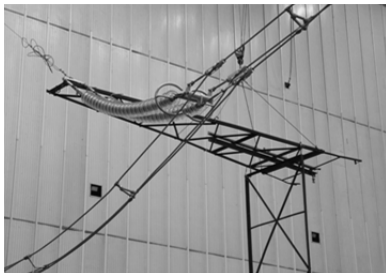
Rys. 3. Łańcuch ŁO2 – 400 kV wraz z imitacją głowicy słupa oraz wiązki mostka w polu probierczym
