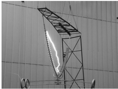
Rys. 6. Łańcuch ŁPV podczas badań wytrzymałości przy napięciu udarowym piorunowym
