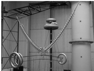
Rys. 2. Łańcuch ŁPV – 400 kV wraz z imitacją głowicy słupa oraz wiązki przewodowej w polu probierczym
