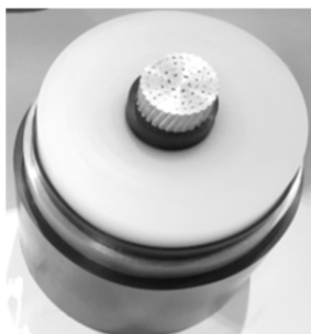
Rys.5. Próbkę kabla XLPE, 800 kV, 630 mm 2 (fot. autorka)
