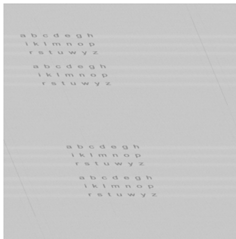
Rys.11. Obraz odtworzony (inwersja) z sygnału emisji ujawniającej mierzonego od drukarki laserowej
