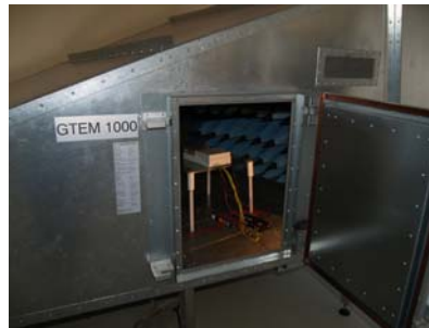
Rys.7. ZEUP Pozyton - licznik EABM przygotowany do badań w komorze GTEM
