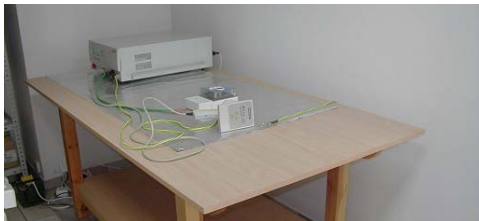
Rys.11. ZEUP Pozyton - stanowisko laboratoryjne do wykonywania testów ESD, "burst", "surge".
