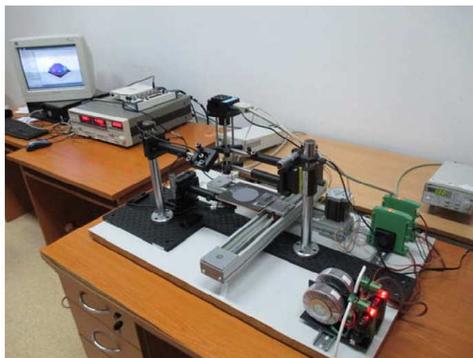
Rys. 2. Fotografia przedstawiająca zrealizowane stanowisko eksperymentalne do mapowania czasów życia nośników materiałach półprzewodnikowych
