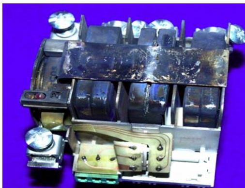
Rys. 5 Ogranicznik nr 2 - deklarowana wytrzymałość udarowa dla prądu 10/350 \mu s 12,5kA - stwierdzono uszkodzenie przy 5,2 kA
