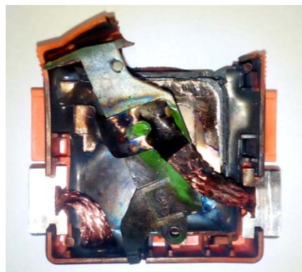
Rys. 4. Ogranicznik nr 1 - deklarowana wytrzymałość udarowa dla prądu 10/350 \mu s 12,5kA - stwierdzono uszkodzenie przy 6,7 kA
