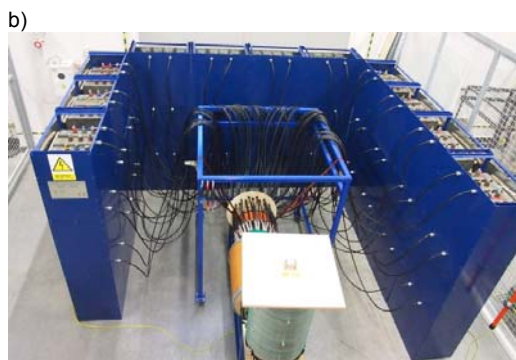
Rys. 3. Generator udarów prądowych: a) schemat układu pomiarowego, b) widok generatora
