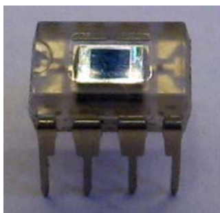
Rys. 9. Układ OPT101: fotografia (po lewej) i schemat ideowy (po prawej)
