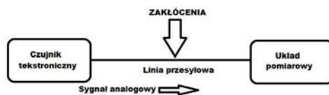
Rys. 3. Ogólny schemat systemu tekstronicznego wykorzystującego czujniki analogowe
