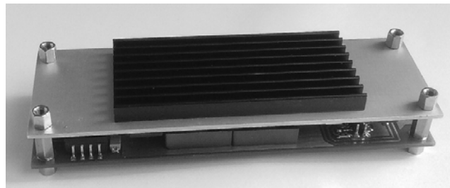
Rys. 4. Przykładowy sposób montażu elementów chłodzących w przetwornicy
