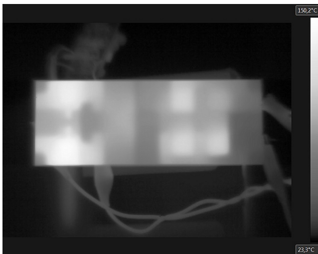
Rys. 6. Rozkład temperatury w układzie zbudowanym na laminacie FR4 - widok od strony laminatu
