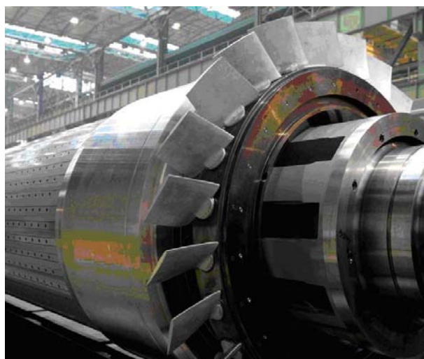
Rys 5. Wirnik turbogeneratorskiego TWW-230 z zmodernizowanym wentylatorem nastawnym
