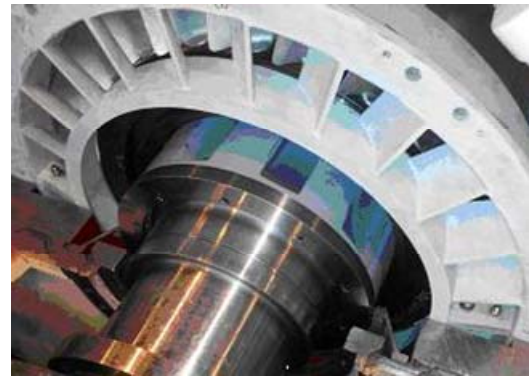
Rys.7. Dyfuzor wentylatora osiowego z łopatkami kierowniczymi przed i po modernizacji
