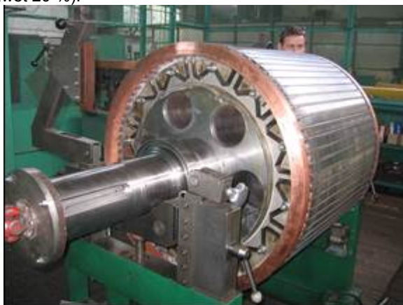
Rys. 2. Wirnik prototypowego silnika synchronicznego z magnesami trwałymi podczas montażu
