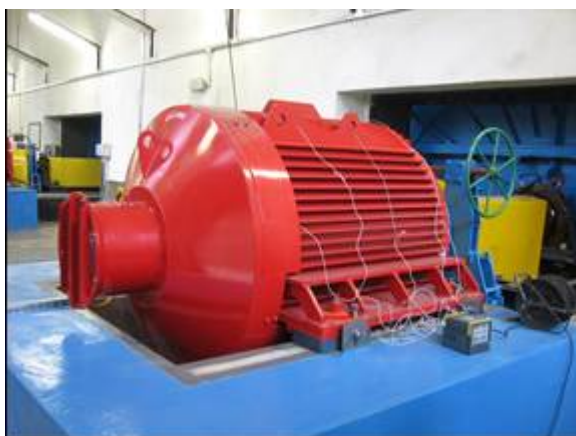
Rys. 3. Prototypowy silnik synchroniczny z magnesami trwałymi zamontowany na stanowisku pracy
