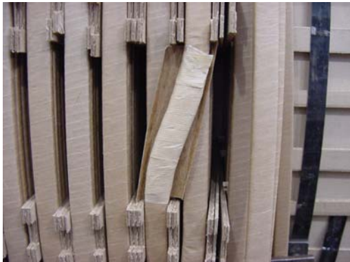
Rys 19. Prawidłowo wykonana i umieszczona przekładka osłaniająca.
