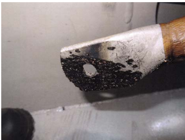
Rys. 5 Ślady wypaleń na końcówce z odpływu uzwojenia DN.
