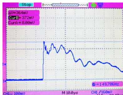
Rys. 4 Przepięcie doziemne na zacisku 2U do ziemi. Atakowany zacisk 1U - Udar pełny 850kV. Wartość szczytowa U_m=62,9kV . Skala napięcia: 17kV/dz., skala czasu: 10µs /dz.
