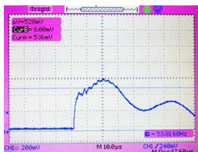
Rys.8 Przepięcie między 2V - Z. Atakowane zaciski GN 1U+1V+1U. Udar pełny 850kV. Wartość szczytowa przepięcia: 98,1kV
