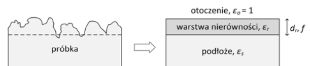
Rys.3. Sposób modelowania chropowatości powierzchni w technice elipsometrii: schematyczna ilustracja próbki pomiarowej (z lewej) oraz odpowiadający jej warstwowy model optyczny (z prawej)
