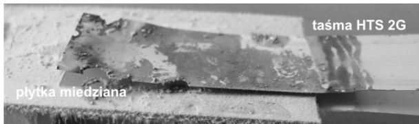
Rys.6. Uszkodzona taśma HTS 2G SF12050 w temp. 77 K, przy prądzie zwarciovym szczytowym i_p = 500 A)
