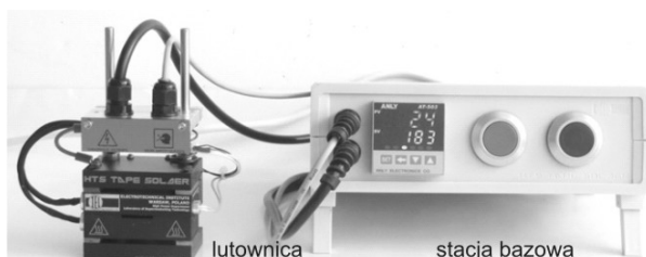
Rys.11. Stacja lutująca taśm nadprzewodnikowych (PTN IEI)
