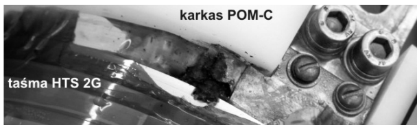
Rys.7. Uszkodzona taśma HTS 2G SF12050 w uzwojeniu nadprzewodnikowego ogranicznika prądu [3]
