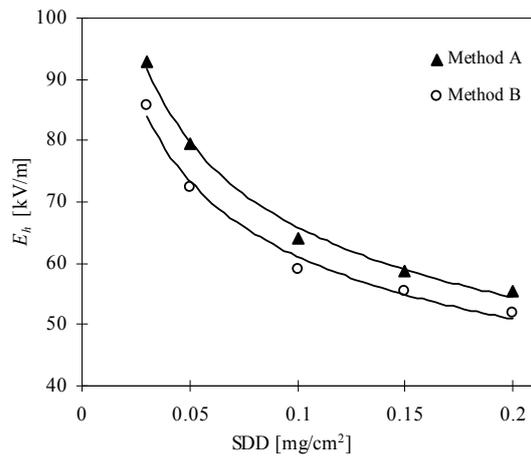
(d) DC flashover voltage gradient of type C insulator string
