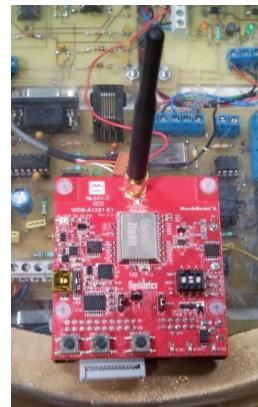
Fig. 5. The ZigBee module
