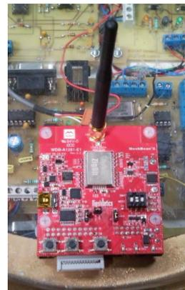
Fig. 5. The ZigBee module
